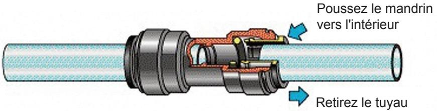
Poussez fermement le tuyau dans le raccord associé, jusqu'au bout. Essayez d'extraire le tuyau pour vérifier que tout soit bien sécurisé. Si le tube se ressort, repoussez-le de nouveau à l'intérieur.
